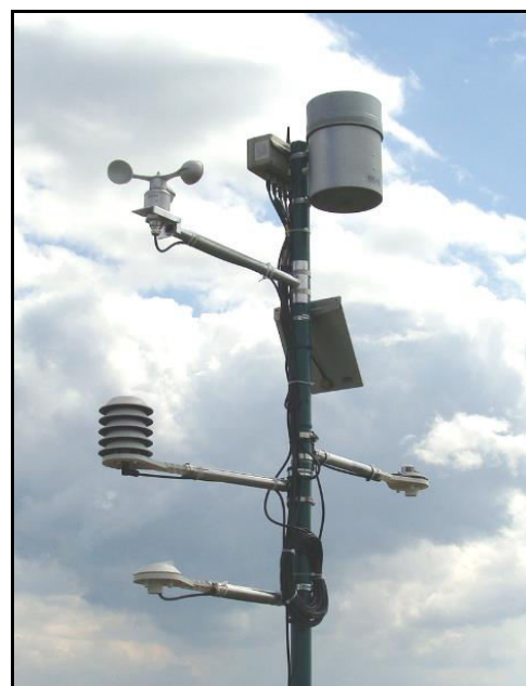
Fig. 2. Piesele de echipament ale stației meteo pentru agricultură
