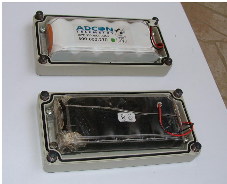
Fig. 1. Baterie Adcon Telemetry montată în capacul stației (sus) și baterie de proveniență incertă explodată (jos)
